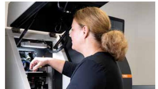
Mit dem vom Fraunhofer IMWS entwickelten Gerät microPREP™ lassen sich ultradünne Proben für die Nanoanalytik schneller und zuverlässiger herstellen.
