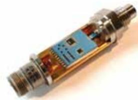
*Der im Projekt entwickelte Demonstrator für Turbinenanwendungen.*
