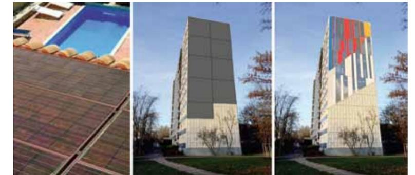
Abbildung links: Denkmalschutzkonforme Nachrüstung mit Photovoltaikmodulen als Anwendungsbeispiel für farbige Photovoltaikmodule. Abbildung rechts: Schwarze und farbige Photovoltaikmodule als nachgerüstete Fassade eines Wohnblocks in Halle-Neustadt (Fotomontage).
