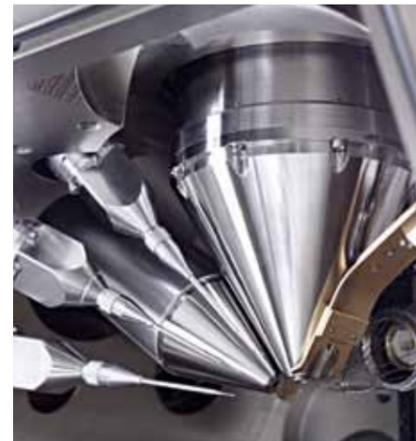
Ein zusätzlicher fokussierter Ionenstrahl in einem Rasterelektronenmikroskop wird genutzt, um einen präzisen Materialabtrag zu erzielen.
