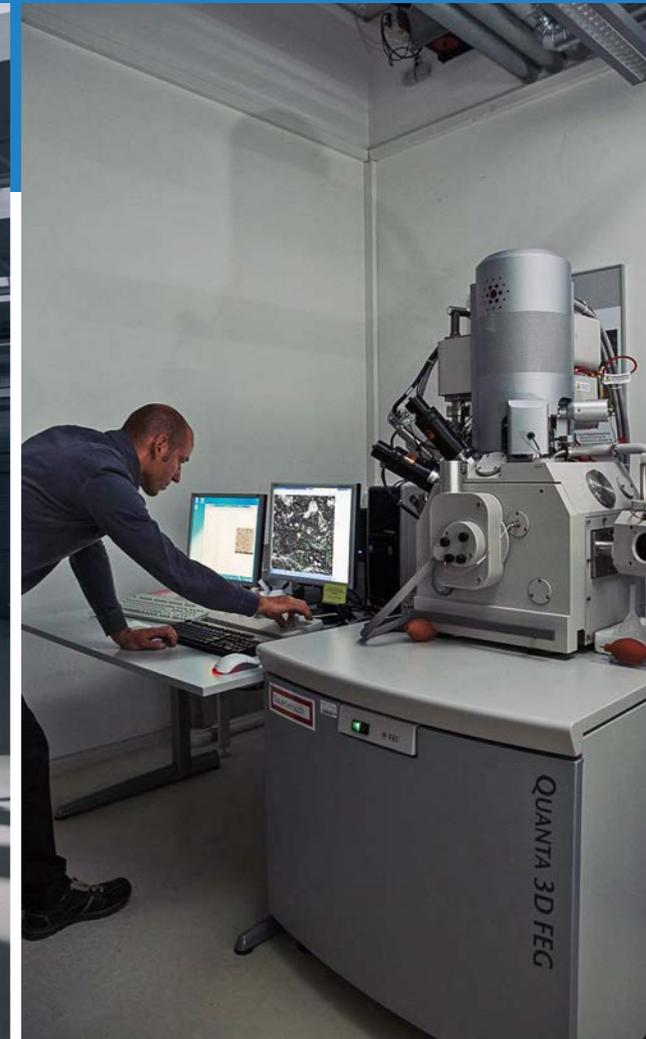
*Mit fokussierten Ionenstrahlen werden im ESEM-FIB-System biologische Materialien in höchster Auflösung untersucht.*
