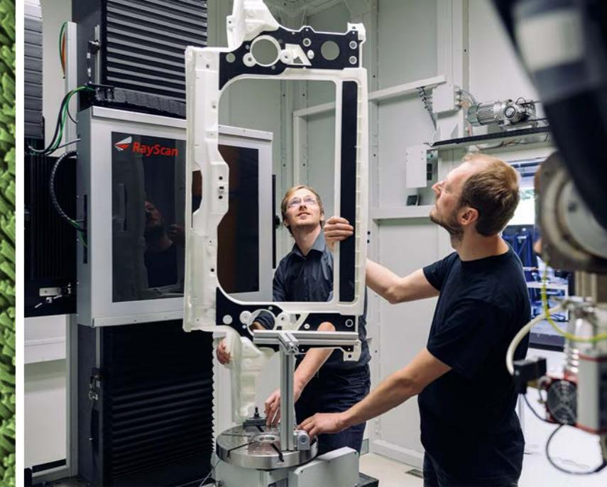
*Ein Pkw-Frontendträger aus faserverstärktem Kunststoff wird in der Röntgen-CT-Anlage untersucht.*
