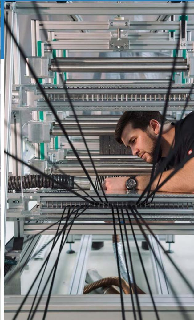
*Mit der UD-Tape-Anlage können auch biobasierte Kunststoffe verarbeitet werden – mit bis zu 15 Metern pro Minute.*
