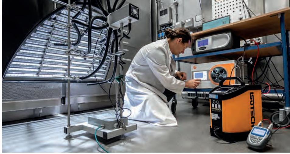
*Kalibrierung der Lufttemperatur- und Luftfeuchtemessgeräte in der kalorimetrischen Klimakammer.*
