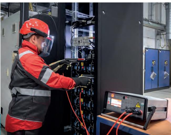
*Manuelle Vermessung eines Batteriespeichers am Fraunhofer ISE.*
