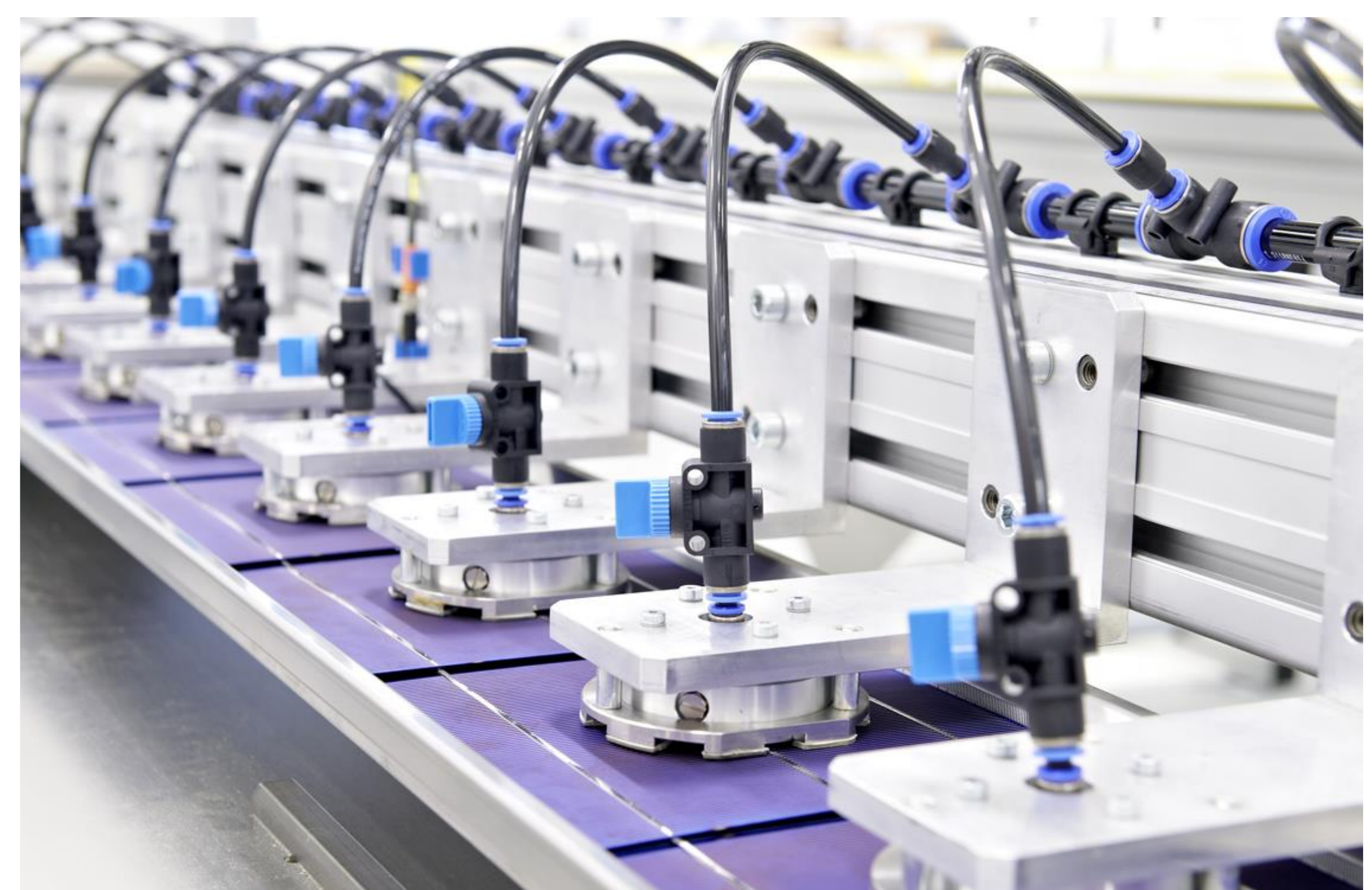
Zellstring-Layup und Querverbinderverlötung für bis 12fach-Zellstrings
